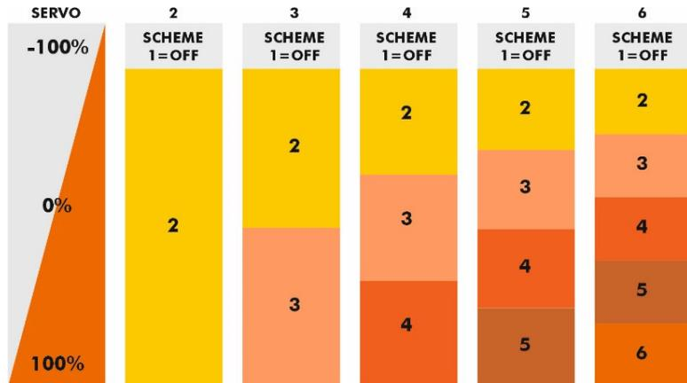
Wählen Sie 3 nutzbare Lichtschemas, dann wird der Servoweg für diese drei Schemas genutzt, also bei -100% alles aus, bis etwas über 0% wird Schema 2 aufgerufen und darüber hinaus wird Schema 3 aufgerufen.
