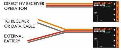
Im uniLIGHT System können Lichter einfach parallelgeschaltet werden. Daher sind 4 Funktionen für die meisten Anwendungen auch ausreichend. Verbindungen können per Y-Kabel oder auch durch einfaches zusammenlöten erstellt werden. Bei der Economy 4 sollte nicht mehr als 3-4 Leuchten der 040 Type parallel an einem Kanal betrieben werden.
