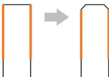
Um die Gängigkeit und Lebensdauer zu erhöhen können die Kanten der Messerleiste abgefeilt werden.
