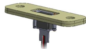
11. Nach der Trennung kann die Messerleiste jetzt verschraubt und damit gesichert werden.
