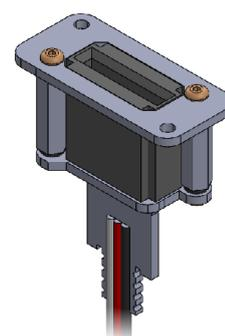
6. Einbaubeispiel A: versenken Sie die Sockelleiste komplett in der Stirnseite der Wurzelrippe am Rumpf.
