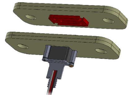
10. Wenn der Bereich grob frei ist, wird in den ausgeräumten Bereich in der Flächenwurzel etwas Heißkleber, dickes Epoxy oder Silikon gefüllt. Dann die Messerleiste polrichtig in den Sockel am Rumpf setzen und die Fläche wieder auf den Rumpf schieben. Sie verbleibt dort, bis der Kleber getrocknet ist.
